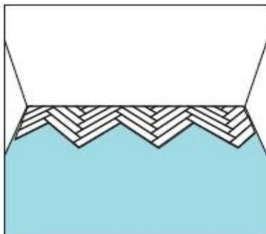
**13. Установите еще несколько линий.** Соедините треугольник и путем добавления нескольких дополнительных линий панелей. Начинайте каждую линию слева направо с панелями А, заканчивайте нарезанными панелями (как в шаге 5), за тем установите все панели В в линию. Завершите левой конечной панелью, отрезанной по размеру.
