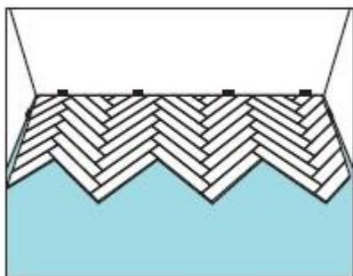
15. **Последующие линии.** Начинайте каждую последующую линию путем установки панелей А слева направо и завершите линию укладкой панелей В справа налево.
