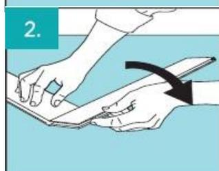
2. **Присоедините следующую панель.** Возьмите панель **В** и подсоедините ее длинной стороной к углу короткой стороны панели **А** как показано на рисунке. Прижмите панель **В** к полу до конца для того, чтобы закрепить. Убедитесь, что пазы на двух панелях образуют непрерывную линию.
