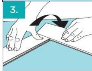
3. **Присоедините следующие панели.** Следующая панель - **А**. Подсоедините ее длинной стороной к углу короткой стороны предыдущей панели **В** и прижмите к полу для закрепления. Продолжайте аналогично, подсоединяя столько панелей, сколько поместится вдоль стены, с которой вы начали укладку.
