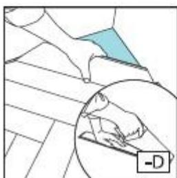
17. **Распорные клинья и плинтуса.** Вытащите распорные клинья и закройте зазоры плинтусом.
